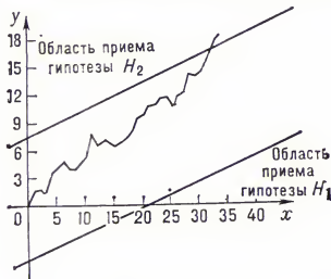
Графическое изображение процесса последовательного анализа.
